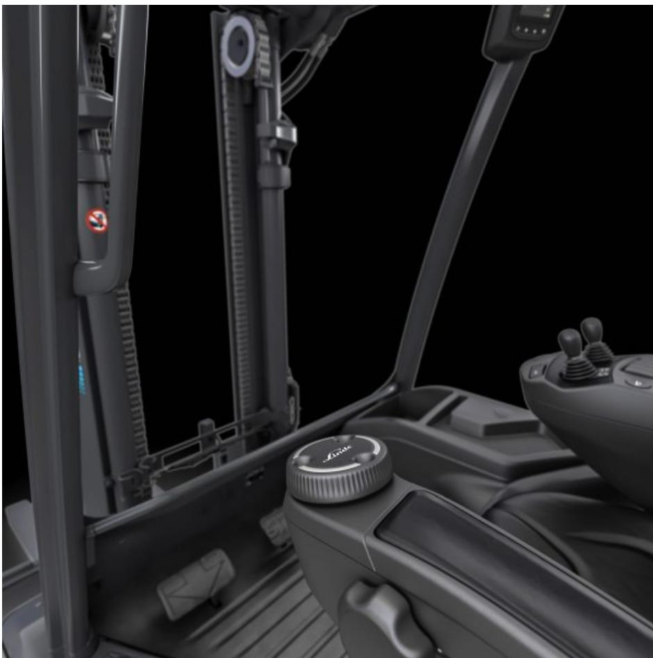
Für klassische Alltagsanwendungen eines Staplers ist das Mini-Wheel gedacht. Die Ähnlichkeit zum gewohnten Lenkrad verkürzt die Umstellungsphase (Bild: Linde MH).
