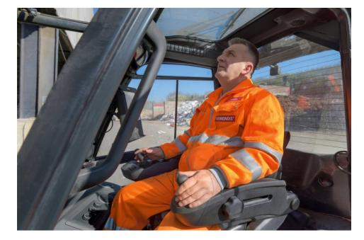
Joystick statt Lenkrad: »Steer Control« entlastet durch entspanntes Sitzen und reduzierte Körperbewegungen das Personal bei der Arbeit (Bild: Linde MH).
