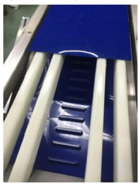
Die quer angeordneten Antriebsnocken auf der Laufseite des Bandes gewährleisten einen vollständig selbstspurenden Betrieb und eine effektive Bandpositionierung (Bild: Habasit).
