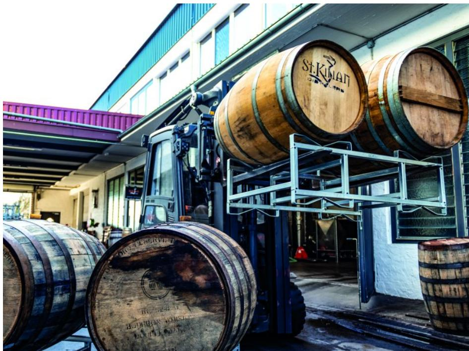
Die robusten Zinkenverstellgeräte können ganz unterschiedliche Transportgüter aufnehmen, was ist in der Whiskyproduktion häufig der Fall ist (Bild: Kaup).
