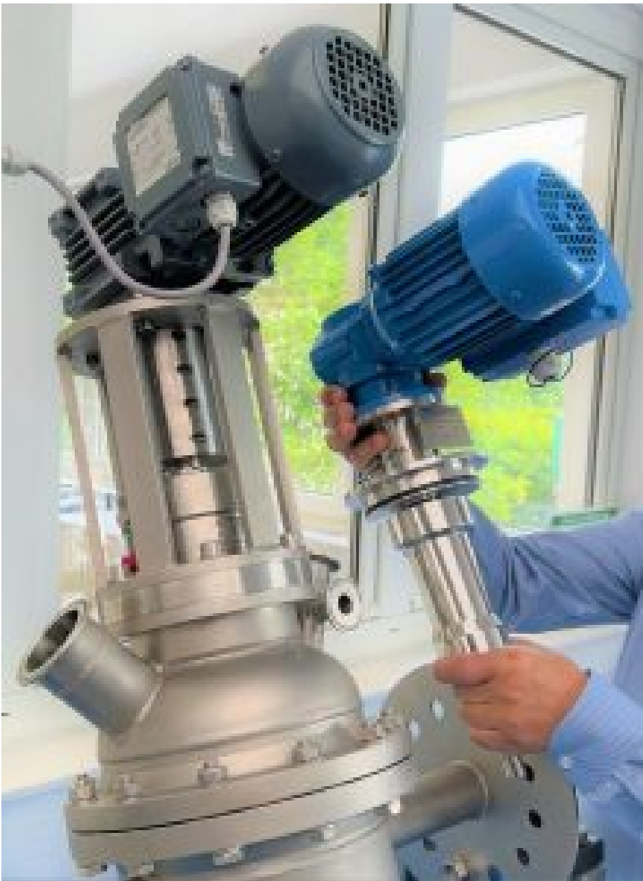
Das neue leistungsstarke Aufsetzmagnetrührwerk mit innenliegender Magnetkupplung (rechts in Blau) kommt ohne Wellendurchführung aus. Es ersetzt den bisherigen Elektroantrieb (links) mit doppelter Gleitringdichtung zur Wellendurchführung (Bild: Wolftechnik).
