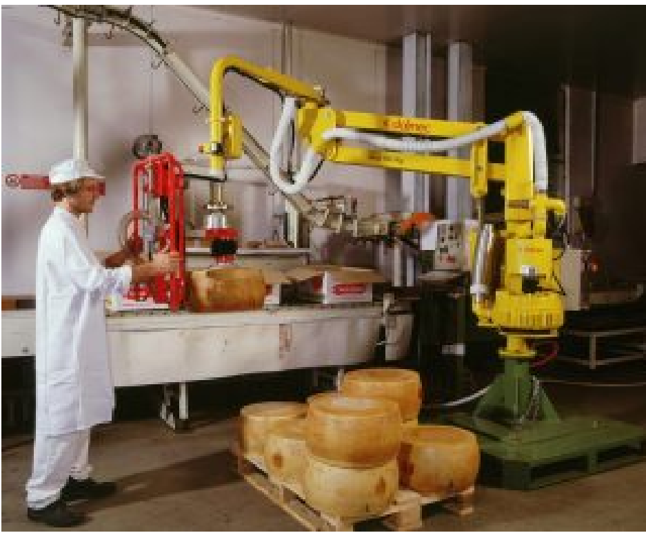
Handhabungsmanipulator mit Saugvorrichtung für das einfache Handling von Käseläuben (Bild: Dalmecc).
