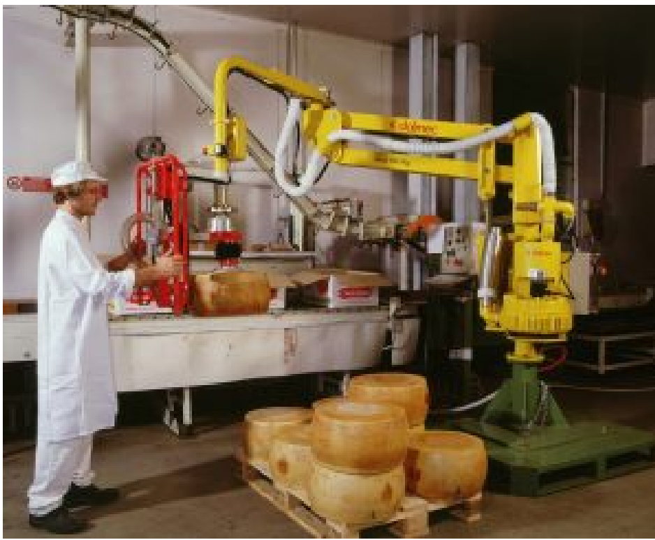
Handhabungsmanipulator mit Saugvorrichtung für das einfache Handling von Käselaiiben (Bild: Dalmecc).
