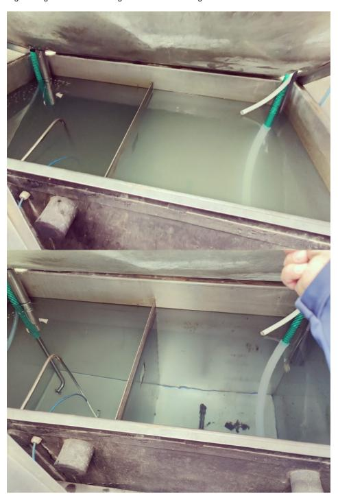
Kühlwasser behandelt mit herkömmlichem Biozid (li.) und danach mit »Anolyte« innerhalb derTrinkwasserverordnung (Bild: Innowatech).
