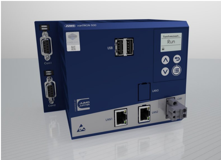
Zentraleinheit des neuen Automatisierungssystems »variTron (Bild: Jumo).
