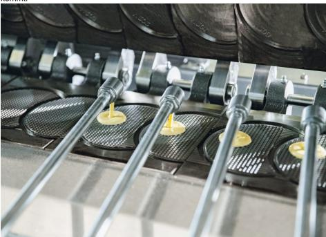
Formprozess am Beispiel von Eistüten: Der Teig wird auf einzelne Backplatten aufgegossen, die mit bis zu 0,5 Metern pro Sekunde durch den Ofen zirkulieren. Am Ende des Prozesses wird die Waffel zu einer spitzen Tüte geformt (Bilder: Pilz).
