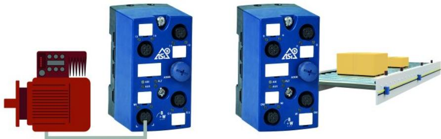
Für Rollenantriebe mit 24-VDC- oder 48-VDC-Spannungsversorgung sowie für Drehstrommotoren mit Frequenzumrichter verschiedener Hersteller stellt Bihl+Wiedemann ein umfangreiches Portfolio von ASi-3- und ASi-5-Motormodulen zur Verfügung (Bild: Bihl+Wiedemann).
