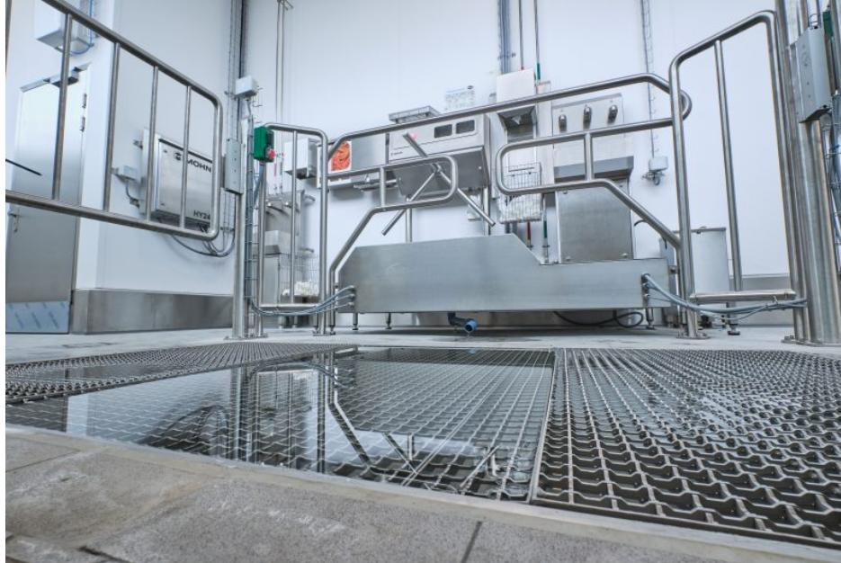
Jede Person, die die Produktionsräume betreten möchte, wird durch die Anlage geführt, deren Drehkreuze erst freigegeben werden, wenn die Reinigung bzw. Desinfektion der Hände erfolgt ist (Bild: Mohn).
