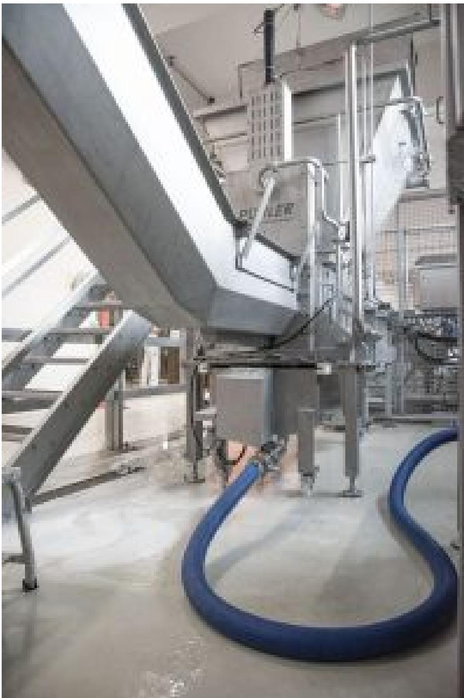
Auffangwanne mit Schlauch zum Abpumpen der Rework-Milch (Bild: Weima).
