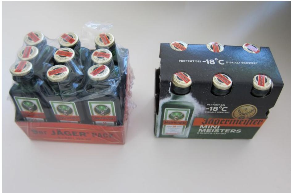
Für Jägermeister wurde ein völlig neuer Verkaufskarton entwickelt, der für automatisierte Verpackungsprozesse optimiert ist und ohne Schrumpffolie auskommt (Bild: Gerhard Schubert GmbH).
