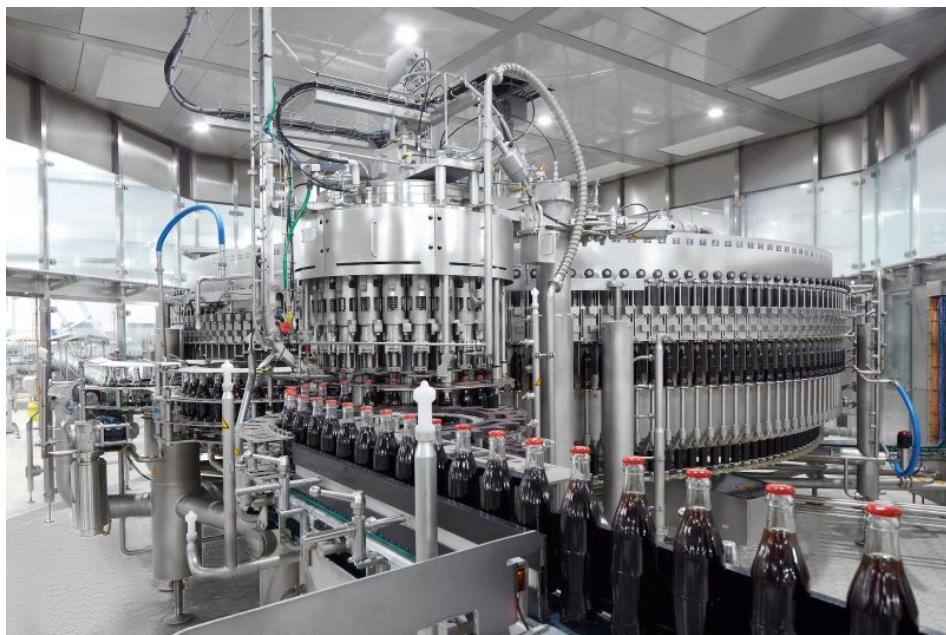
Teil der Glaslinie in Mannheim ist der KHS-Füller »Innofill Glass DRS«, der bis zu 60.000 Flaschen pro Stunde verarbeiten kann (Bild: KHS).
