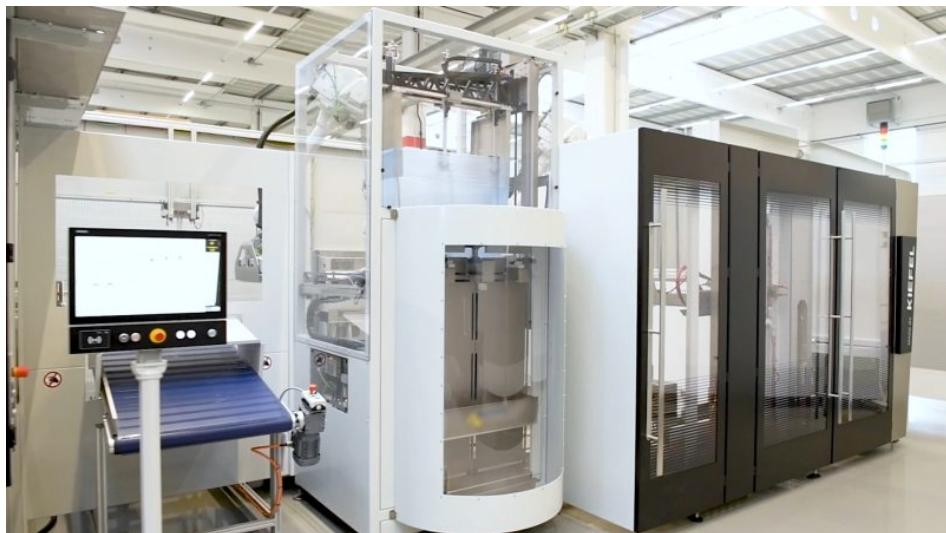
Die einzelnen Module der Automatisierungslösung – im Bild Beuteleinleger und Kartonverschließer – können an bestehende sowie neue Thermoformmaschinen angeschlossen werden (Bild: Kiefel).
