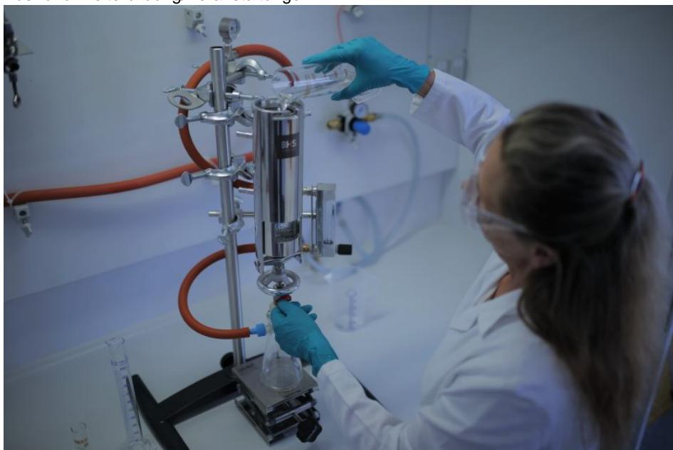
Das Taschenmessgerät für Laborversuche, das auf der Filtech gezeigt wird, hilft bei der Filterauslegung. Bild: BHS-Sonthofen
