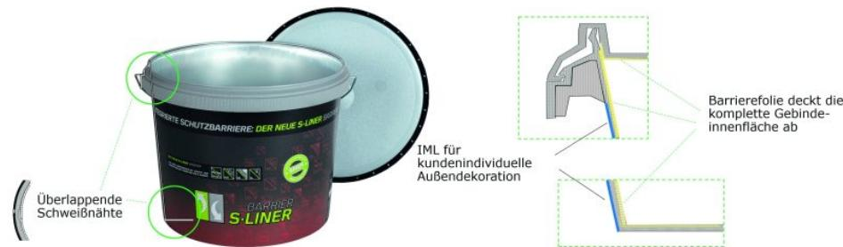
Prinzip der »S-Liner Barrier«-Innenfolientechnik (Bild: Saier).
