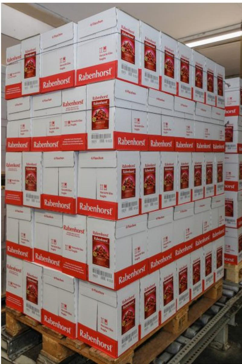
Eine fertig gestapelte Palette – hier im typischen fünfflagigen Aufbau mit insgesamt 120 Transportkartons – auf dem Weg ins Pufferlager. Durch zwei kurze Hotmelt-Raupen auf jedem Umkarton erzielt der Frucht- und Gemüsesafthersteller Haus Rabenhorst eine hohe Stapelsicherheit auf den Versandpaletten (Bild: Kimberly Wittlieb).
