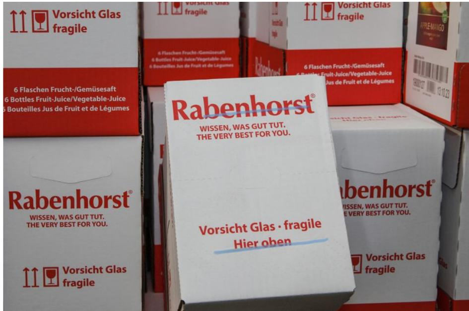
Zwei circa 11 Zentimeter lange Hotmelt-Raupen – im Bild zur besseren Visualisierung blau eingefärbt – gewährleisten eine rutschfeste Palettierung (Bild: Kimberly Wittlieb).
