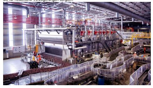
Große Maschine mit kleinem Energie- und Ressourcenverbrauch: Die KHS-Reinigungsmaschine »Innoclean DM« nutzt vergleichsweise wenig Wasser (Bild: KHS).
