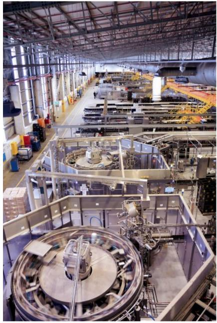
Dreh- und Angelpunkt der Linie sind die beiden KHS-Füller »Innofill Glass DPG Eco« (Bild: KHS).
