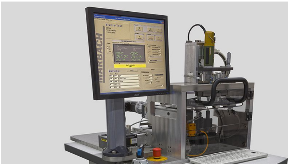
Prägemaschine für Braillepatrizen (Bild: Marbach).
