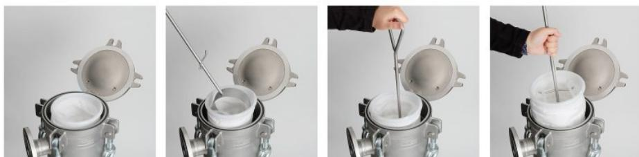
Einfacher Austausch mit der Filterbeutel-Einbau-/Ausbauhilfe (Bild: Wolftechnik).
