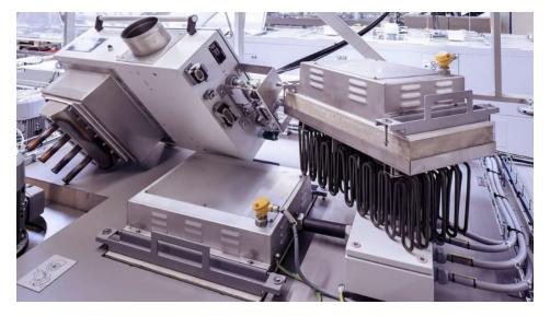
Mithilfe von Gas- und Elektrokassetten können KHS-Kunden die Energiequelle ihres Schrumpftunnels wechseln. Zudem besteht die Möglichkeit, die Anlage zwischen zwei Gasarten umzuschalten oder auf Elektrizität flexibel umzurüsten (Bild: KHS).
