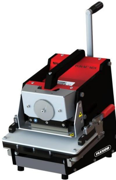
Mit der mobilen Fingerstanze lassen sich exakt geformte Finger für hochwertige Endlosverbindungen stanzen (Bild: Flexco Europe).
