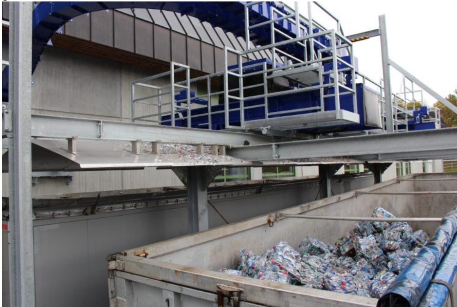
Rinnenausschub in den Walking-Floor-Auflieger. Bild: Strautmann
