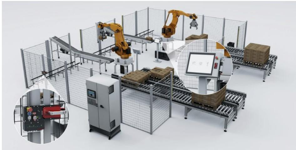
Das sichere Schlüsselsystem lässt sich für zahlreiche Anwendungen entlang des Verpackungsprozesses einsetzen (Bild: Euchner).
