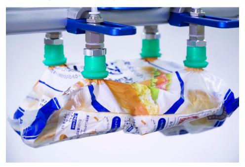
Dank weicher Dichtlippe und stabilem Balg greift der Balgsauggreifer auch faltige Beutel zuverlässig (Bild: J. Schmalz).
