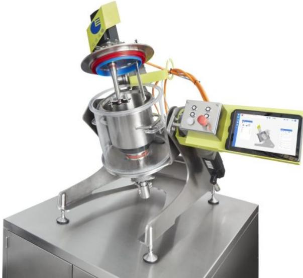
Der neue Fünf-Liter-Prozessor (Bild: Eirich).
