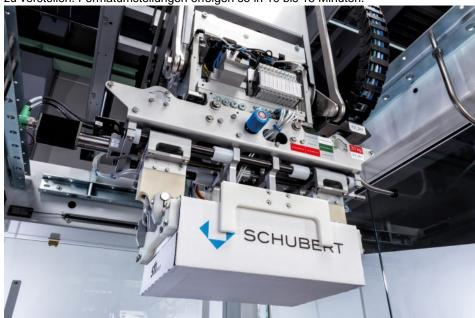
Die vollautomatisch verstellbaren Roboterwerkzeuge sind wie jedes konventionelle Roboterwerkzeug von Schubert wechselbar. Bild: Schubert
