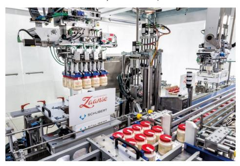
Die »TLM«-Maschine verpackt 15 verschiedene Produktformate und 13 verschiedene Produkte in verschiedenen Größen und Formaten von 250 bis 1000 Milliliter. Bild: Schubert
