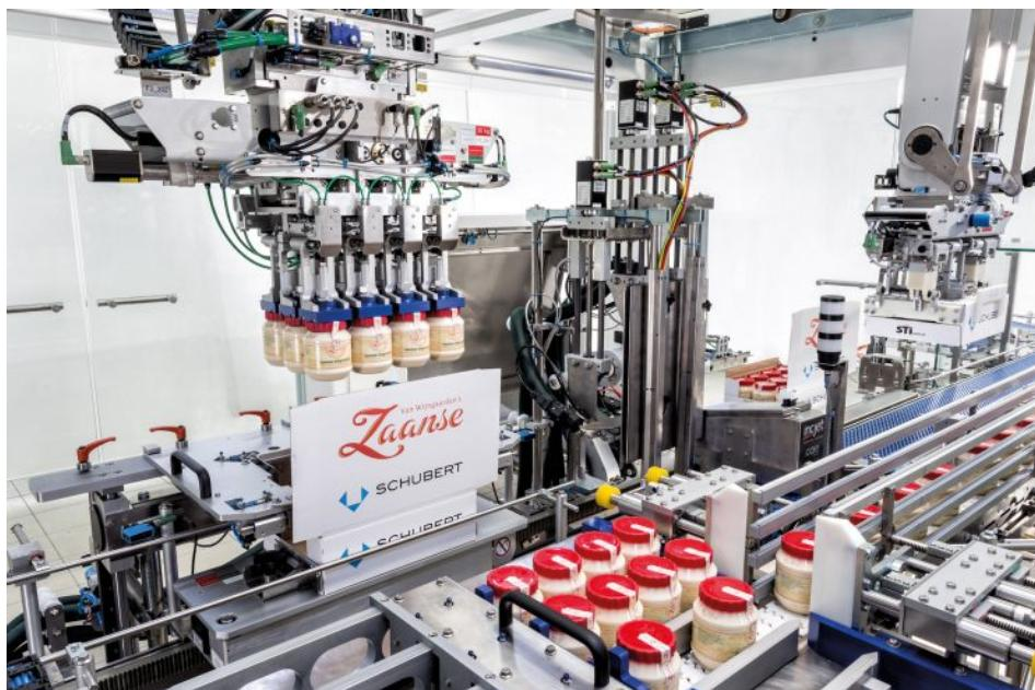
Die »TLM«-Maschine verpackt 15 verschiedene Produktformate und 13 verschiedene Produkte in verschiedenen Größen und Formaten von 250 bis 1000 Milliliter. Bild: Schubert
