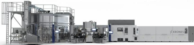
Mit der Hochleistungs-Abfüllanlage können bis zu 100.000 bph abgefüllt werden (Bild: Krones).
