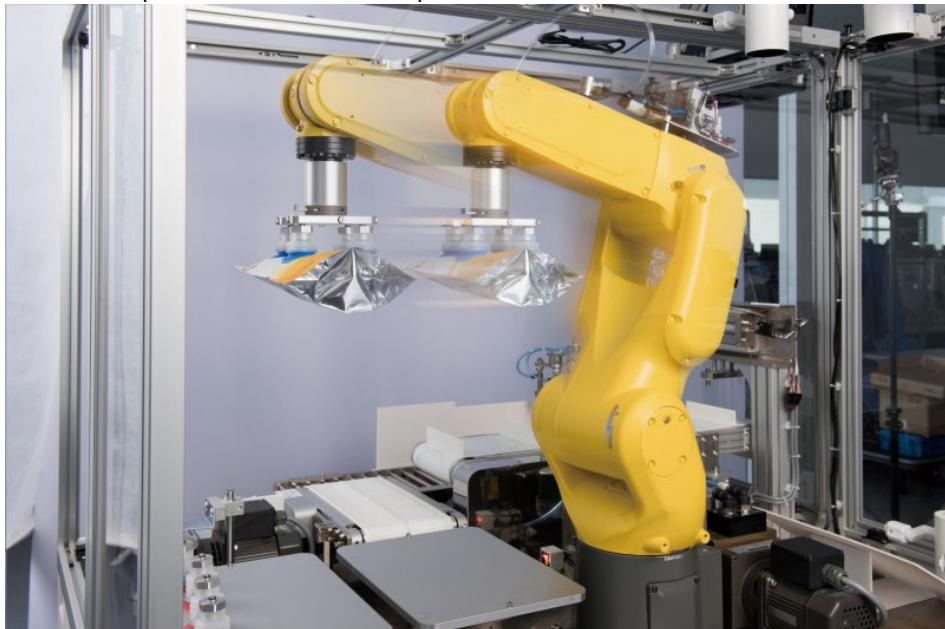
Die neuen 2K-Balgensauger eignen sich auch für das Handling von Beuteln mit starkem Faltenwurf (Bild: Fipa).
