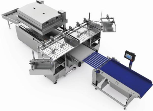
Die halbautomatische Lösung steigert die Effizienz beim Einbeuteln (Bild: Multivac).
