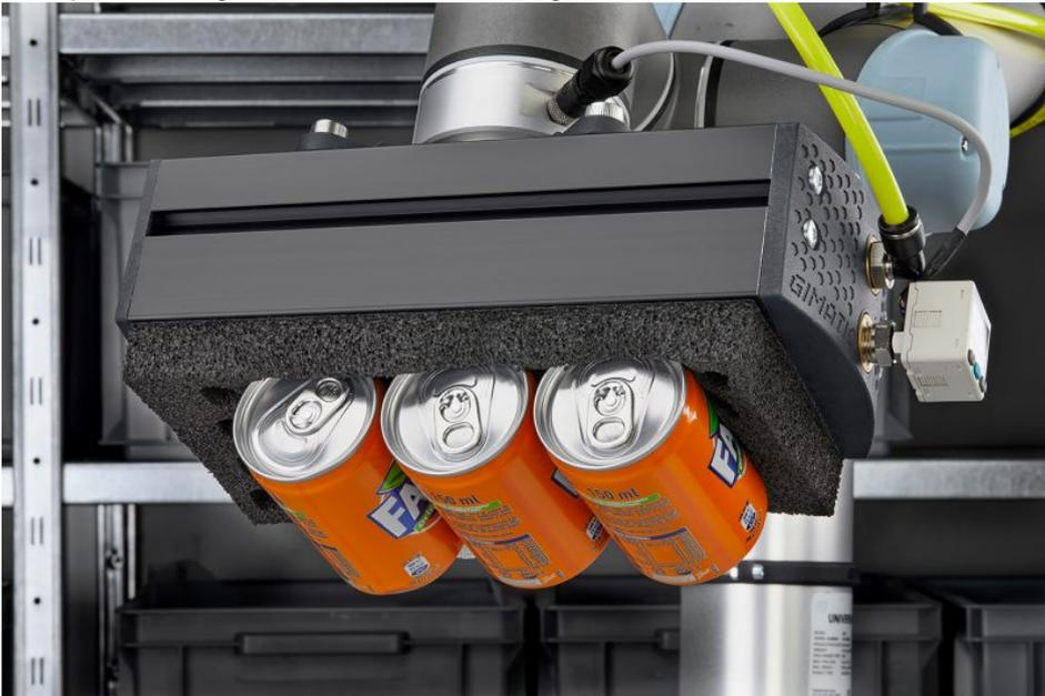
Mit den Vakuum-Flächengreifern können Blech, Holz, Karton, Dosen, Glas und Kunststoffe sicher transportiert werden (Bild: Gimatic).
