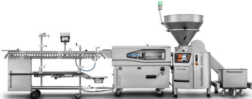
Hochleistungs-Würstchenlinie mit schwenkbarer Aufhängeeinheit und -Waage (Bild: Handtmann).
