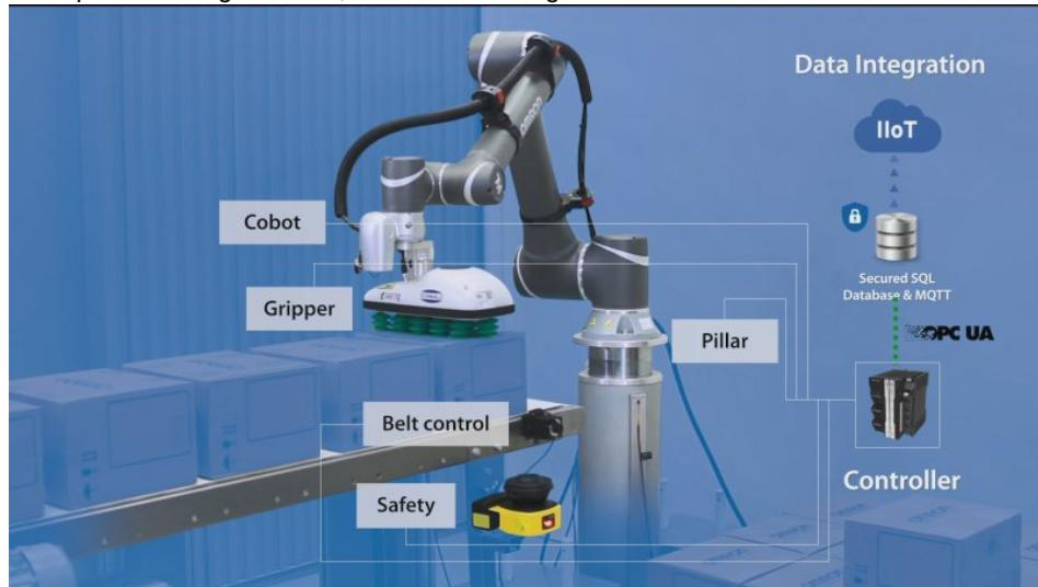
Die neue Cobot-Palettierlösung ermöglicht ein schnelles und einfaches Umrüsten durch schnelle Definition von Palettenmustern (Bild: Omron).
