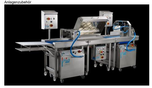
Die Bandanlage zur Veredelung von Feingebäck basiert auf modularen, zugelieferten Komponenten aus Edelstahl (Bild: häwa).
