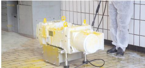
Die Vakuumpumpen sind für die tägliche Reinigung geeignet und spülbar mit Flüssigkeiten im Inneren (Bild: Leybold).
