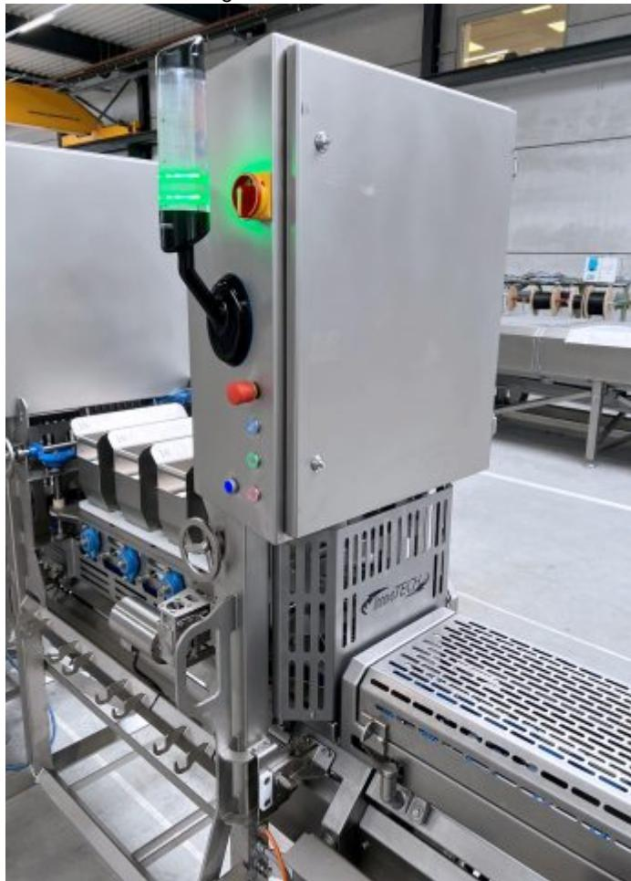
Die LED-Signalsäule wurde speziell für den Einsatz in der Lebensmittelproduktion entwickelt (Bild: Werma).
