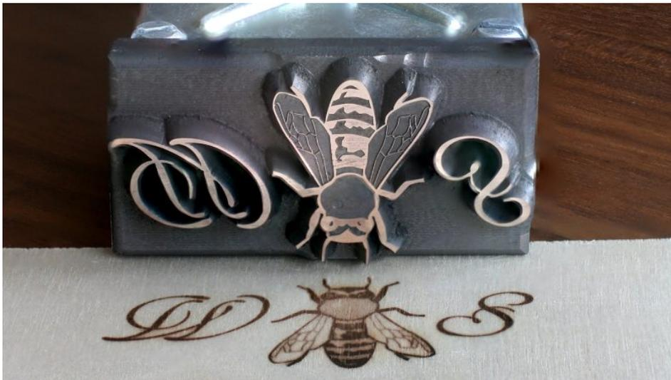
Dank spezieller Technik und hochwertigen Komponenten können auch Braunabstufungen gebrannt werden (Bild: Gravierbetrieb Wagner).
